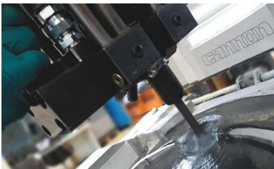
Cannon EG-AX System zur optimalen Verarbeitung von Blähgraphit als Flammenschutzmittel in flexiblen PU-Schäumen. Fotos: Cannon Group
