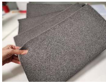
Cannon EG-AX System zur optimalen Verarbeitung von Blähgraphit als Flammenschutzmittel in flexiblen PU-Schäumen. Fotos: Cannon Group
